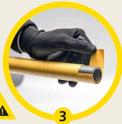
Dénuder les 6 premières ondes à l'aide d'un cutter dans le cas des DN15, DN20, DN25 et DN32. Dénuder les 5 premières ondes pour le DN40.
