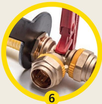
Serrer l'écrou à la main puis à l'aide de clés plates adaptées, jusqu'en butée, sans couple de serrage. Lors du serrage de l'écrou, le corps du raccord reste fixe.
