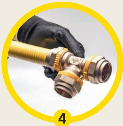
Insérer le tuyau dans le raccord jusqu'à la butée, lorsqu'on entend le «CLIC». La partie inox doit complètement disparaître.
