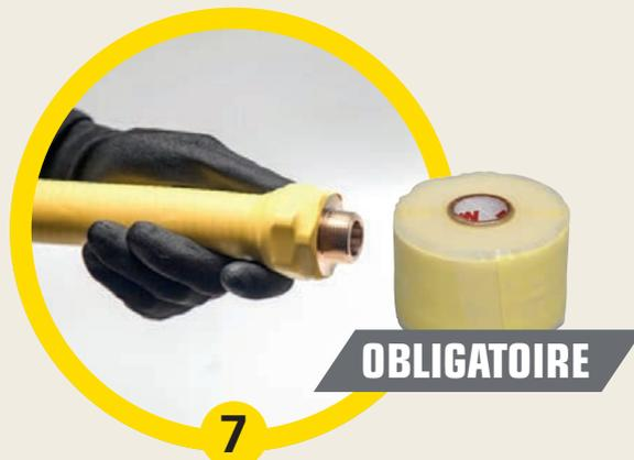
Le revêtement de protection supprimé lors de la mise en œuvre ou de l'assemblage des raccords des kits de tuyaux onduleux pliables BD CONNECT doit être reconstitué après réalisation d'un test d'étanchéité par l'emploi des bandes adhésives recommandées. L'attention doit être portée sur la nécessité de ne pas influencer le résultat des opérations de vérification de l'étanchéité du système.
