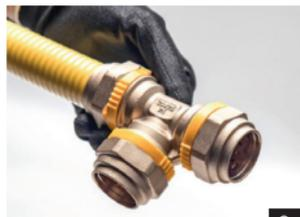
3 Insérer le tuyau dans le raccord jusqu'à la butée. Enfoncer le tuyau jusqu'à disparition complète de la partie inox.
